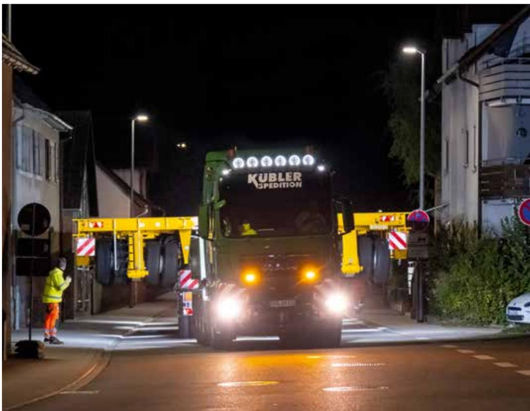
Robuste Achslinien: 18 Achslinien SCHEUERLE InterCombi unterstützen den erfolgreichen Transport. Insgesamt 250 Tonnen Gesamtgewicht und 40 Meter Gesamtlänge misst jeder der 2 Konvois. Engstellen meistert Kübler mit Bravour.
