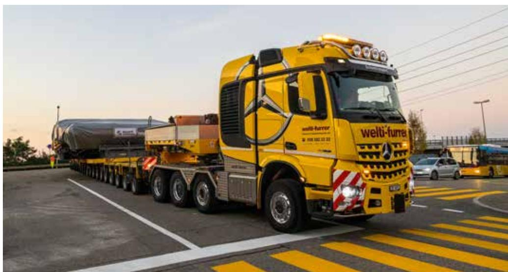
Gleich ist die zusätzliche Zugmaschine angekoppelt und der Zug-/Schubverbund kann die Reise antreten.
