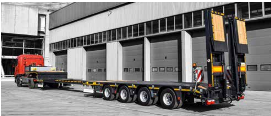
Der K.SLH 4 bietet eine maximale Plattformverlängerung von bis zu 6.200 mm.
