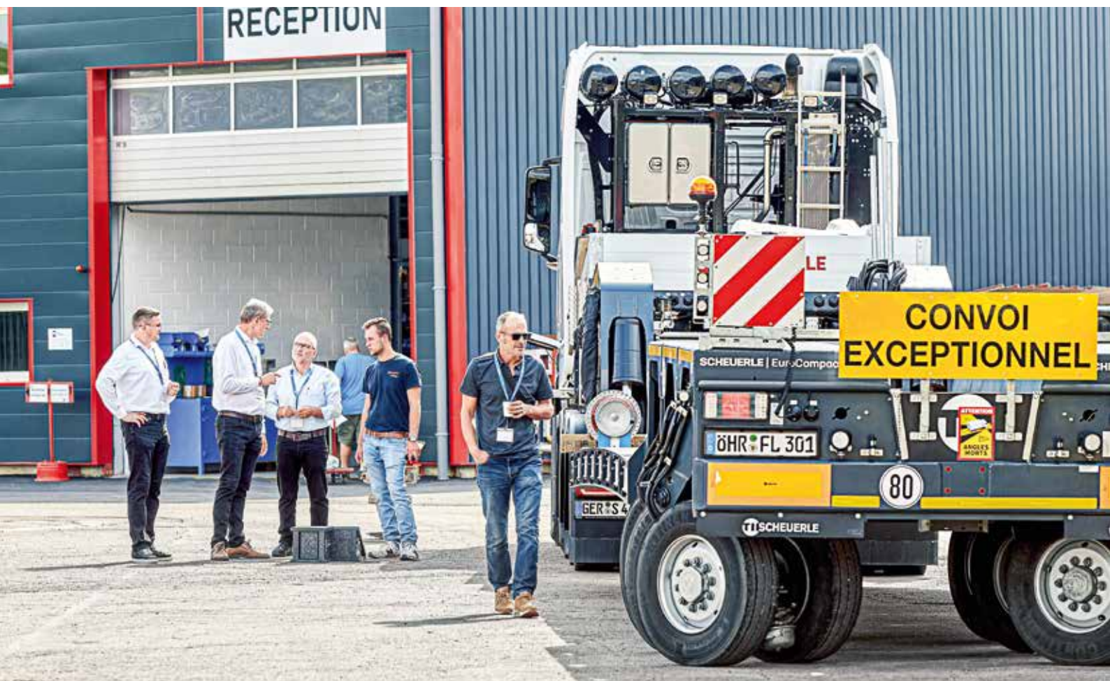
Der Tiefbettauflieger der Baureihe EuroCompact U9 mit der Achsformel 0+3 am Kundentag in Champs-sur-Yonne.
