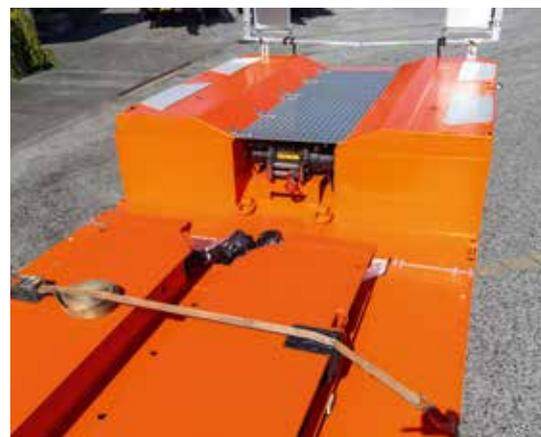
Zu den zahlreichen Sonderausstattungen zählt beispielsweise eine Seilwinde an der Löffelstielmulde im Fahrwerk.
