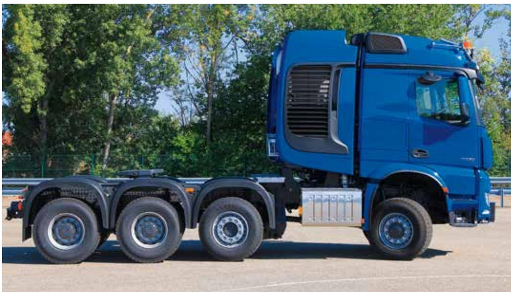
Mercedes-Benz Arocs 4-Achser JZAI 8x6 4: Umbau durch CTT von 6x6 Sattelzugmaschine auf 8x6/4 Full-SLT durch Einbau der vierten Achse und aller notwendigen Ausstattung für den Einsatz im Schwerlastverkehr mit Lastzuggesamtgewichten bis 500 Tonnen.
