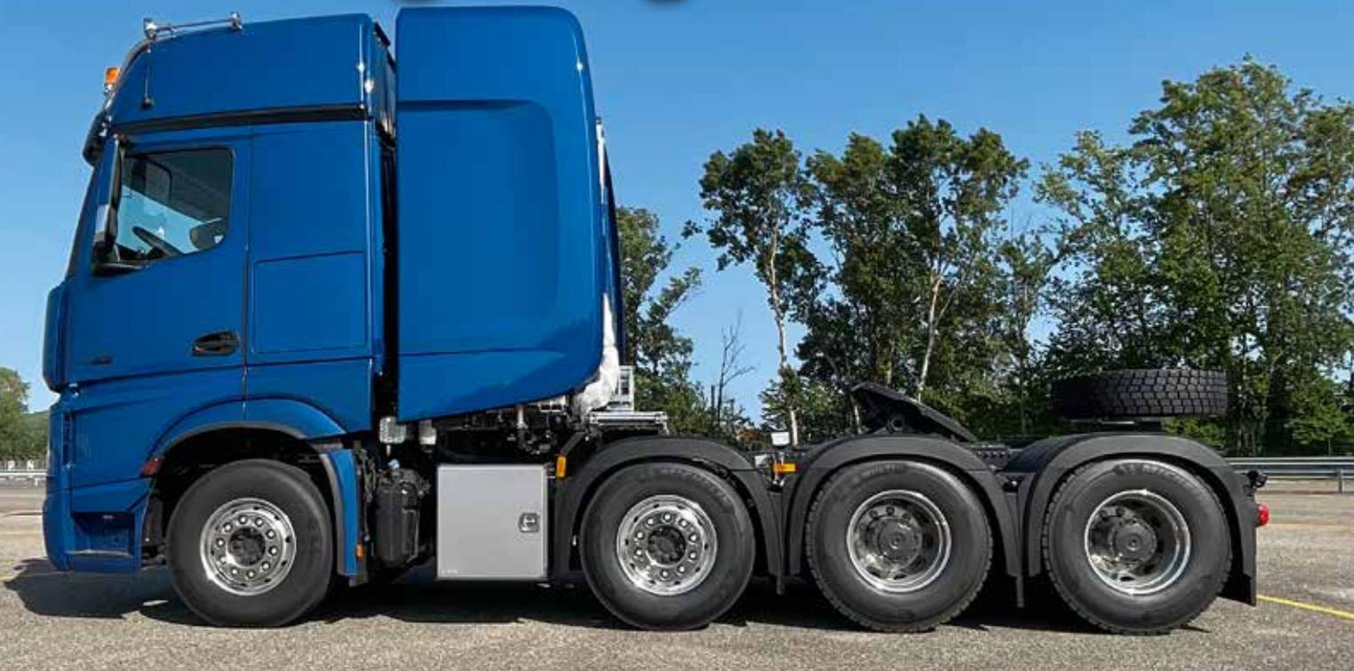
Das Jubiläumsfahrzeug ist ein Mercedes-Benz Actros 8x4/4 Full-SLT für den Einsatz im Schwerlastbereich.
