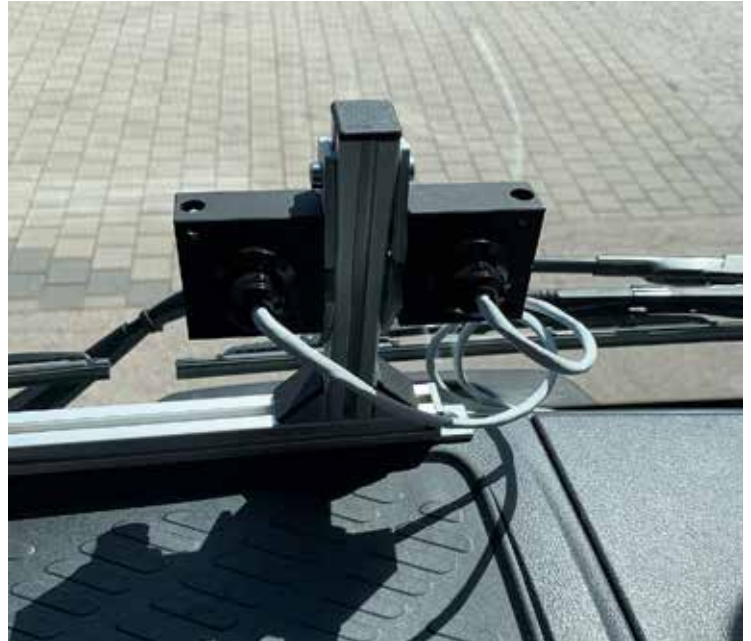
Ferner sind die Testfahrzeuge mit zusätzlichen Kameras ausgestattet, wie hier zu sehen auf dem Armaturenbrett in der Mitte der Windschutzscheibe.
