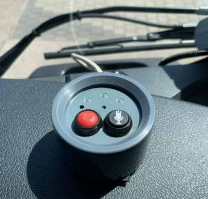
Die Testfahrzeuge verfügen über einen „Notausschalter“.
