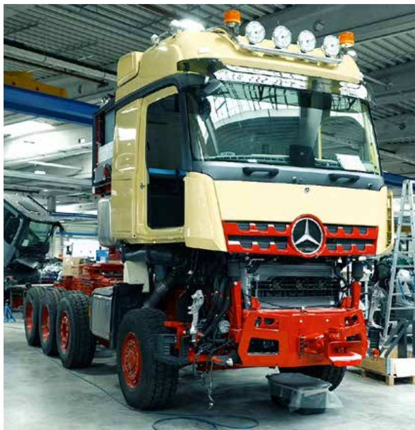
Erneute Hochzeit: das Fahrgestell erhält sein neues Fahrerhaus.
