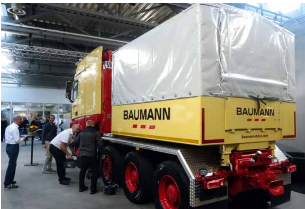
Die Ballastkiste beherbergt auch einen großen 1.000 l fassenden Wassertank.
