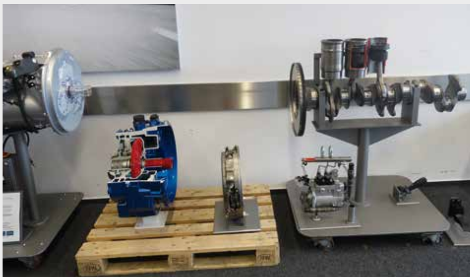
Die Turbo-Retarder-Kupplung (blau) ist zwischen Motor und Getriebe platziert.
