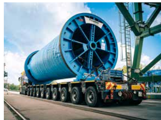
Eine solche Gleichstrom-Kabelrolle hat eine Länge von 10 Metern und ein Gewicht von 80 Tonnen.
