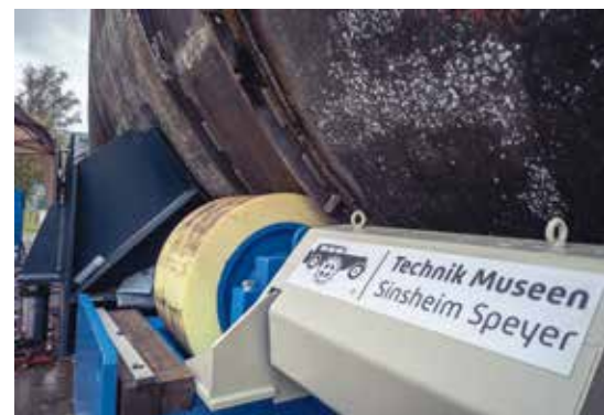
Im Bild: die Drehvorrichtung, mit der U17 um 73 Grad wird. Quelle: TMSNHSP
