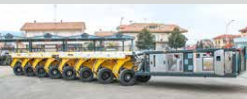
Die beiden 4-Achs-MSPE von Cometto mit einer Power Pack Unit.
