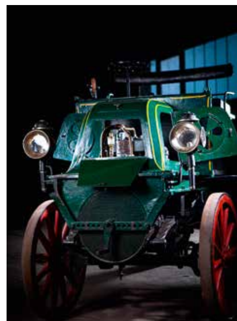
Motorkühlung per Röhrenkühler.
