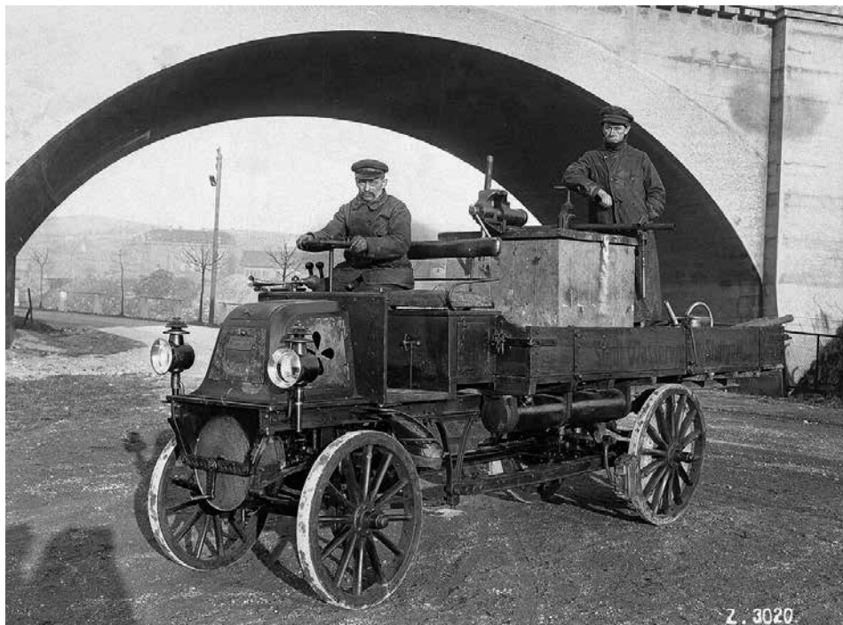
Der Daimler Kardan-Lastwagen der „Staedt. Wasserwerke Stuttgart“ von 1899 im Einsatz. Deutlich erkennbar sind auf dem Foto ...
