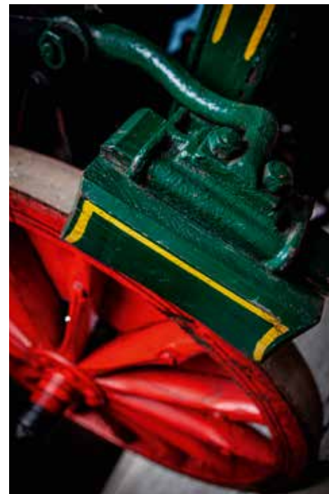
... die Bremsklötze aus Holz an den Hinterrädern.
