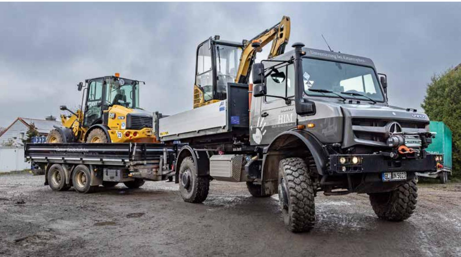
Unimog U 5023 als Abrollkipper mit Hakenlift und Seilwinde.
