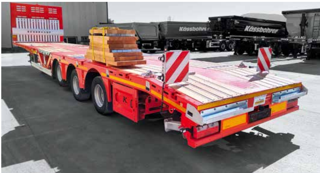
Der Kässbohrer 3-Achs-Teleskop-Tiefbett-Plattform-Sattelaufleger K.SPA MR 2 verfügt über Radmulden.
