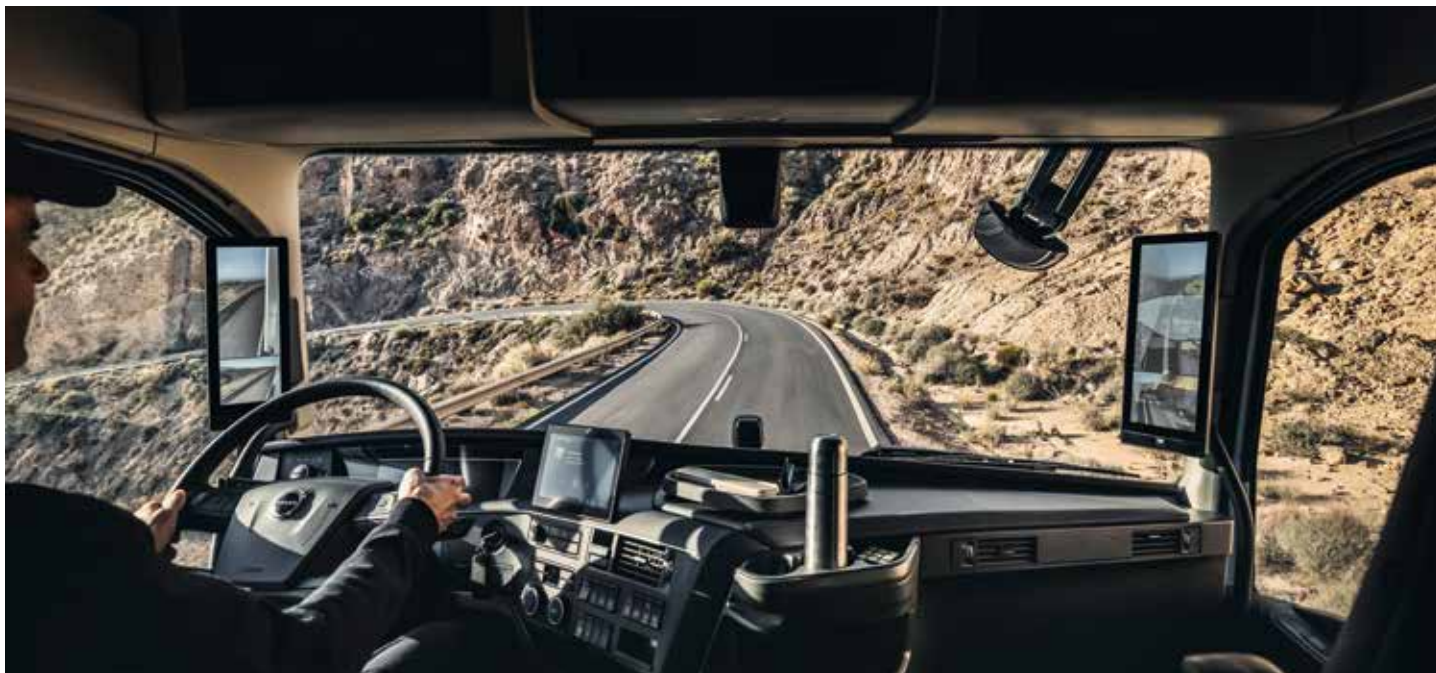
Das Kamerasystem hat eine positive Auswirkung auf die Sicht des Fahrenden bei Regen und Dunkelheit, aber auch bei direkter Sonneneinstrahlung und beim Fahren in Tunneln.
