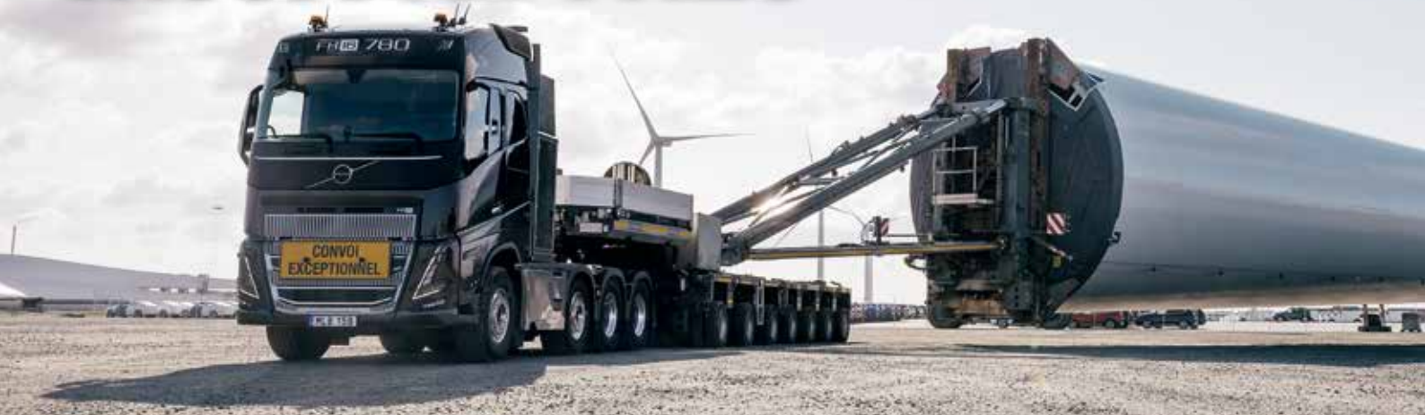
Ein 4-achsiger Volvo FH16 780 transportiert ein großes Turmsegment für eine Windkraftanlage.
