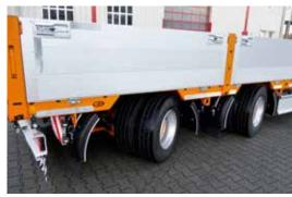
Um auch unter beengten Platzverhältnissen optimal manövrieren zu können, wurde der Zweiachs-Pritschensattel mit lenkbaren Achsen
