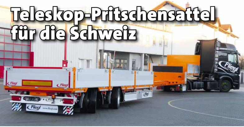
Der Zweiachs-Pritschensattelauflieger vom Typ SZS 440 Jumbo kann auf maximal 17.050 Millimeter Ladelänge teleskopiert werden.
