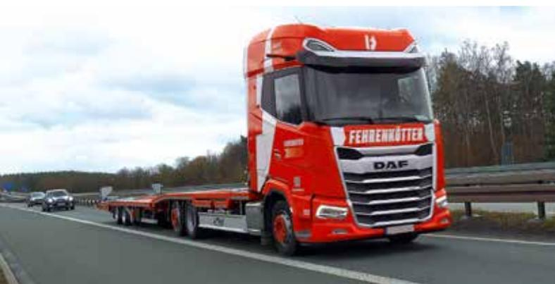
DAF XG+ 530 FAN Low Deck mit Fliegl Tridem-Plateauzug im Einsatz.
