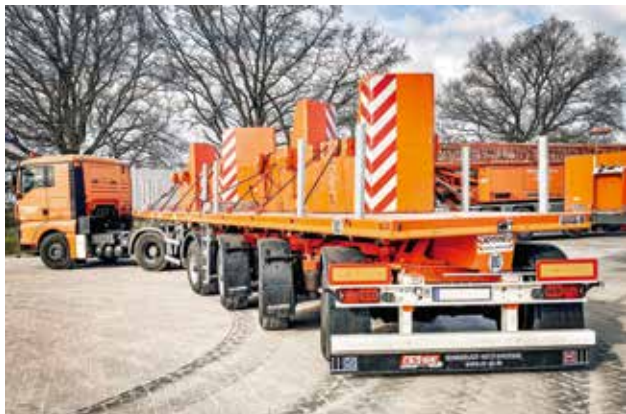
Dank hydro-mechanischer Zwangslenkung bietet der MAX410 von MAX Trailer eine hohe Manövrierfähigkeit.
