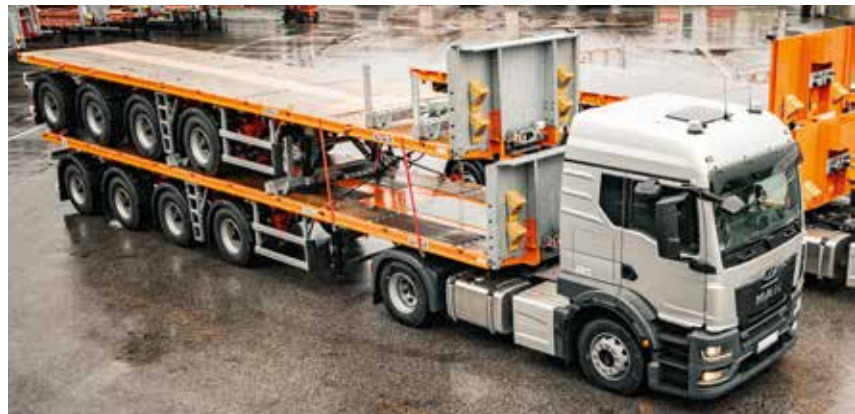
Dank hydro-mechanischer Zwangslenkung bietet der MAX410 von MAX Trailer eine hohe Manövrierfähigkeit.
