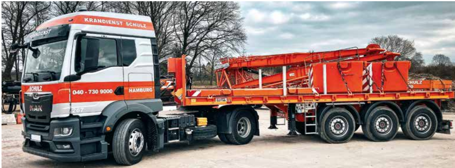
Der ES-GE-Ballastauflieger misst lediglich 8 m Länge und bietet ein zulässiges Gesamtgewicht von 50.000 kg.
