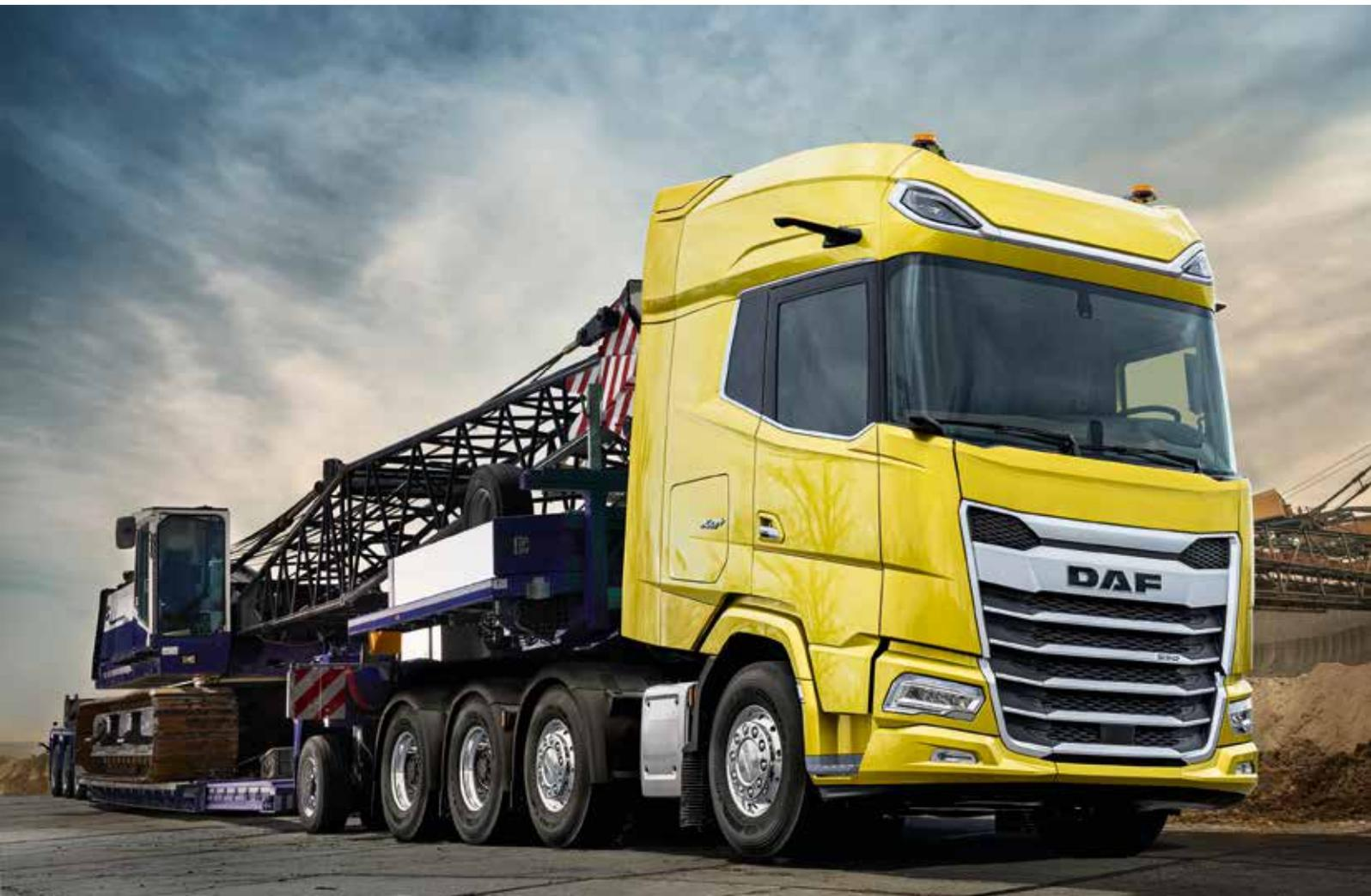
Ein Raupenkran auf einem Tieflader wird von einem 4-achsigen DAF XG+ gezogen.
