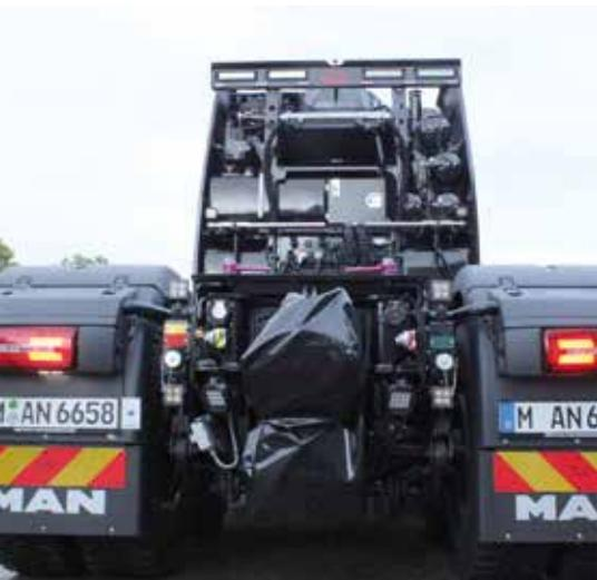
Am Heck ist eine Schwerlasttraverse mit 100 Tonnen-Tiefkuppelbock angebracht.
