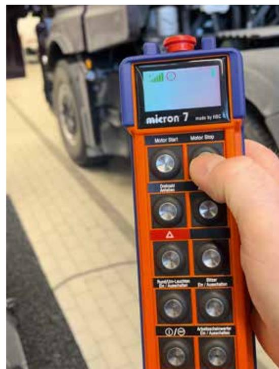
Einzigartig: Die Fernbedienung von HBC Raiomatic, mit der verschiedene Fahrzeugfunktionen aus der Ferne per Funk gesteuert werden können.
