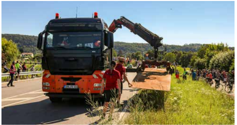
Fanden eher weniger Beachtung, waren aber wichtige Helfer und Wegbereiter: die Fahrzeuge der Firma Fischer, die mit Ladekränen 1.000 qm Aluminium- und 500 qm Stahlplatten verlegten, um insbesondere ein Einsinken der schweren Last zu verhindern.
