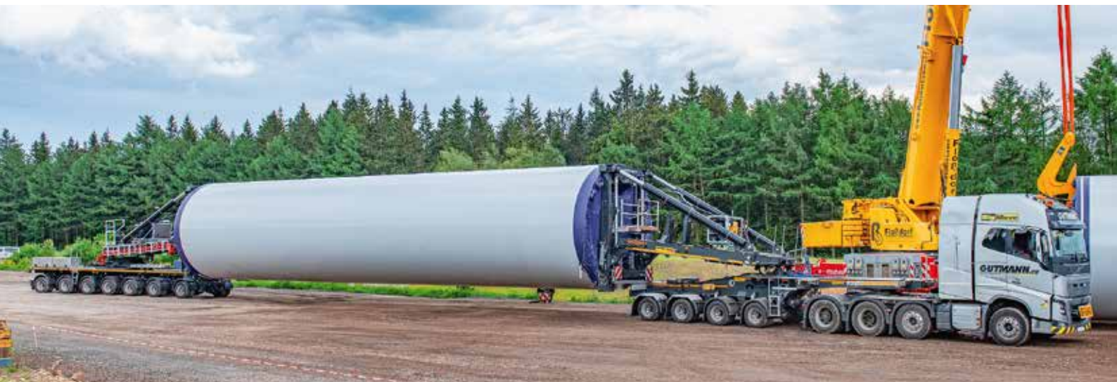
Für die neue Faymonville 4+7 Achs Nachläuferkombinationen mit Adaptern vom Typ FlexMAX war der Transport die Feuertaufe.
