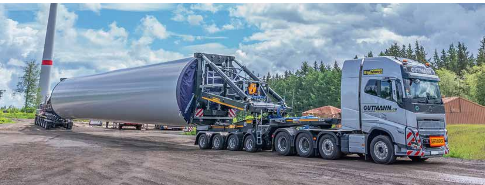
Die Gesamtzuglänge betrug maximal 58 m und das Gesamtzuggewicht 130 t.
