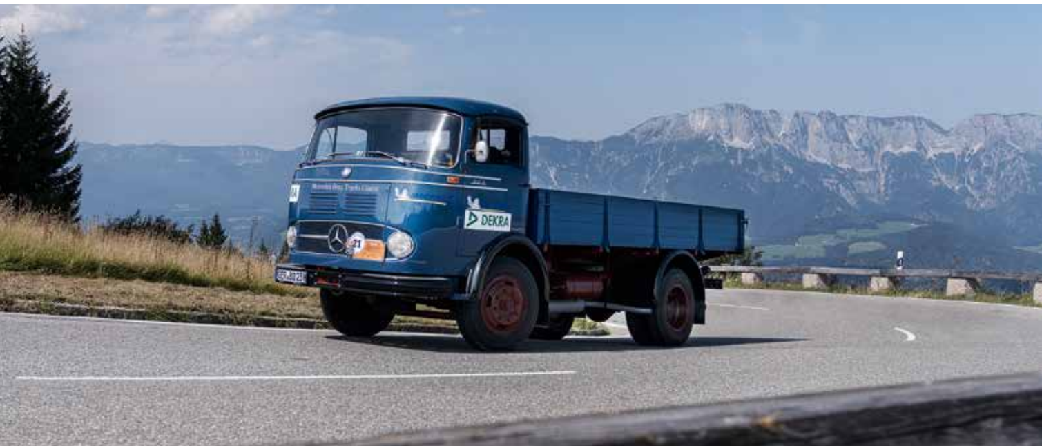
Der MB LP 323: Unverkennbar die Ähnlichkeit zum LP 333 – aber mit nur einer gelenkten Vorderachse, da die „Seeböhm’schen Gesetze“ rividiert worden waren.
