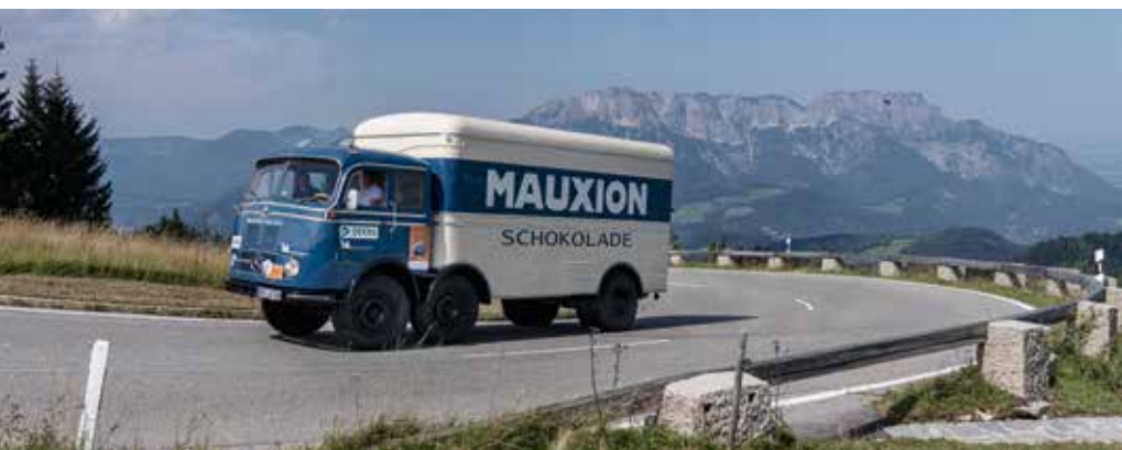
Der politischen Willkür geschuldet und nur kurz produziert: der MB LP 333 mit zwei gelenkten Vorderachsen.
