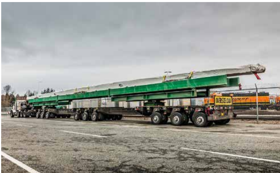
Beim HighwayMAX handelt es sich um einen ausziehbaren Schwerlastauflieger für die Straße mit neun hydraulisch gelenkten Pendelachsen und einer technischen Nutzlast von 260.000 Pfund.
