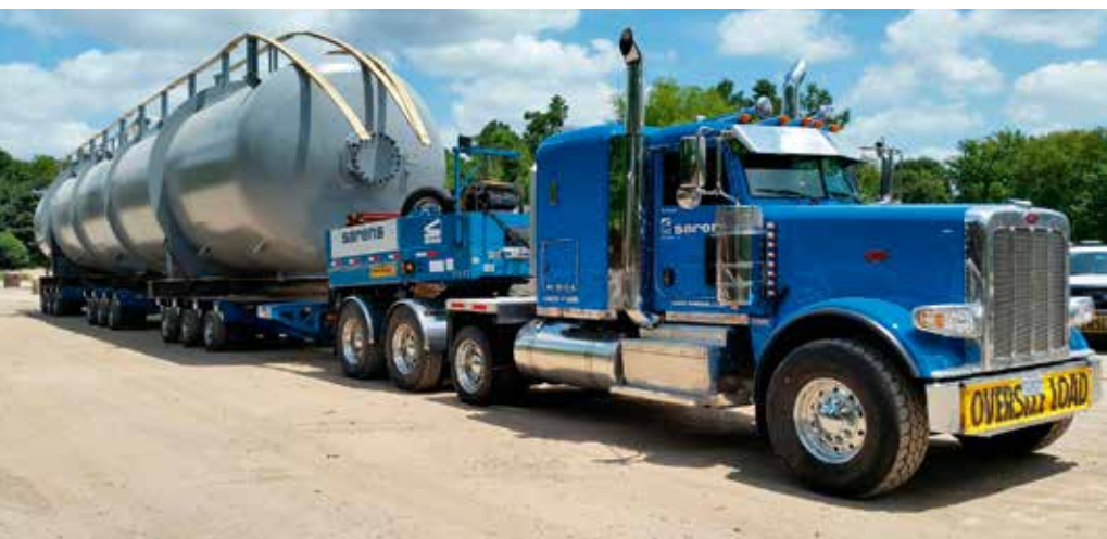
Der HighwayMAX mit Pendelachsen und dem verwindungssteifen Fahrzeugrahmen in Nordamerika,
