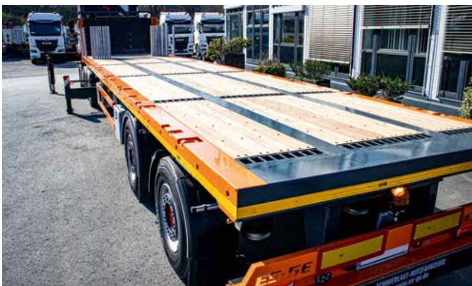
Der ES-GE 2-Achs-Sattelanhänger bietet ein Gesamtgewicht von maximal 36.000 kg.
