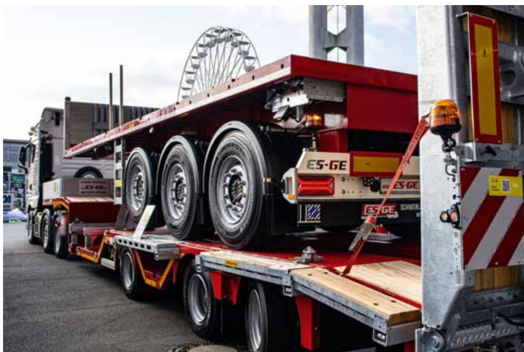
Ein MAX Trailer MAX100 Satteltiefelader hat einen ES-GE Ballastauflieger auf der Ladefläche.
