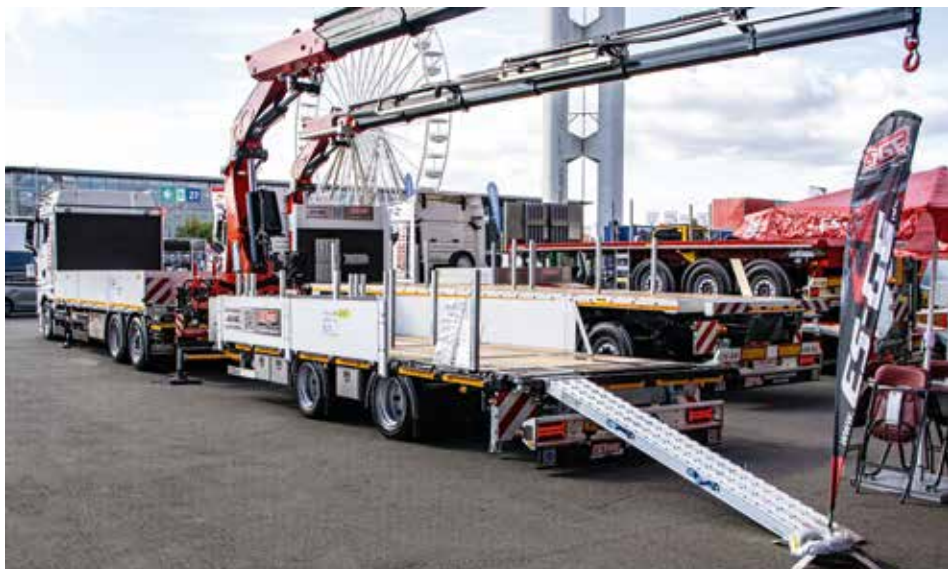
ES-GE hatte zahlreich Fahrzeuge mit Ladekran mit nach Hannover gebracht. Hier ist der Ladekran heckseitig am Ende der Pritsche montiert.
