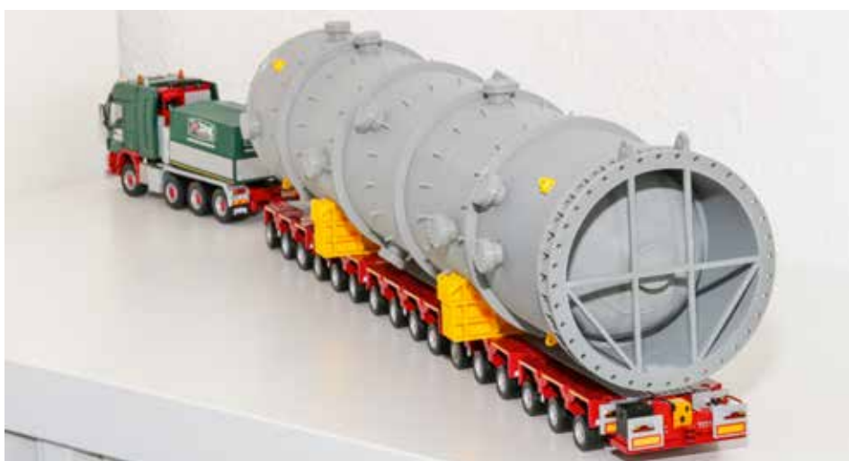
Die Gesamtzugeinheit, bestehend aus Transportfahrzeug und 4-achsiger MB Schwerlastzugmaschine.
