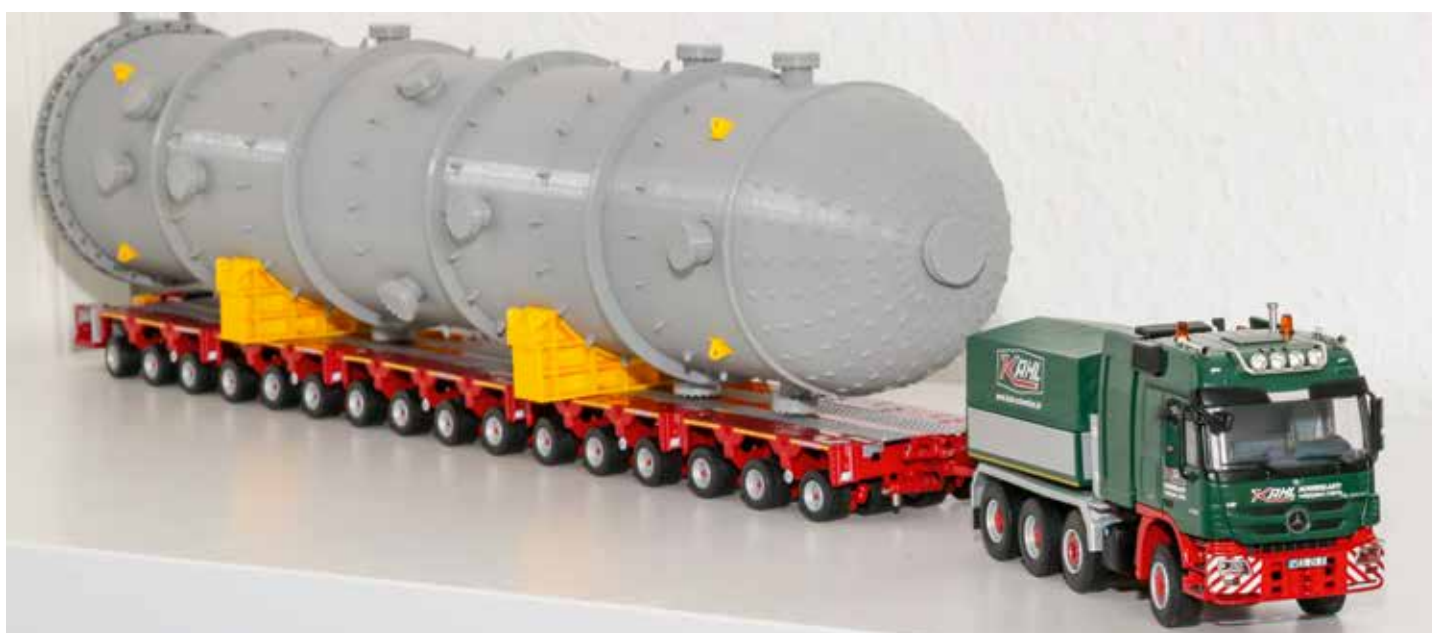
Transportiert wird die Kolonne auf Scheuerle-Transportmodulen, die es auf insgesamt 16 Achsen bringen.
