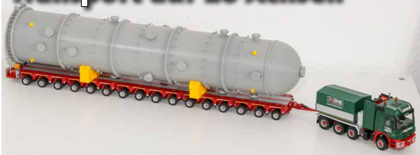
Die Gesamtzugeinheit, bestehend aus Transportfahrzeug und 4-achsiger MB Schwerlastzugmaschine.
