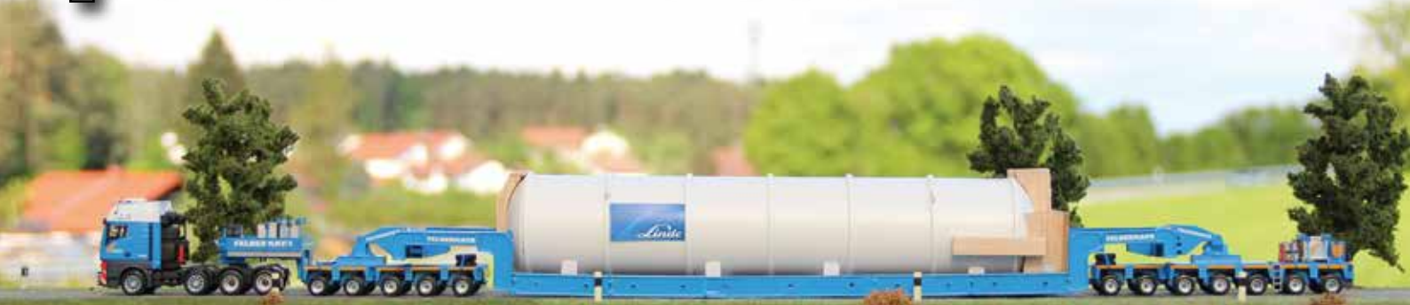
Eine 5+7 Kesselbrücken-Kombination von Felbermayr mit Transportgut der Firma Linde.
