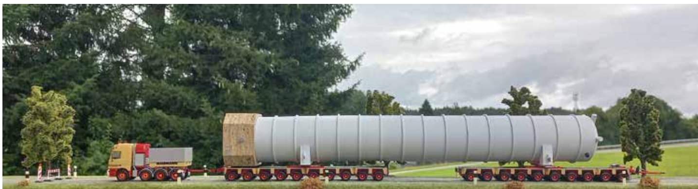
Ein weiterer Baumann-Einsatz: erneut kommt eine 4-Achs-Schwerlastzugmaschine zum Einsatz. Die Last der Fracht verteilt sich jedoch auf zwei Transporteinheiten. Sowohl die vordere als auch die hintere Einheit besteht aus Transportmodulen mit insgesamt 10 Achsen.
