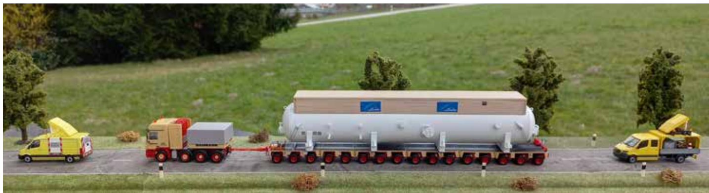
Die Last des Linde-Silos verteilt sich auf Transportmodule mit insgesamt 16 Achsen. Als Zugfahrzeug kommt eine 4-achsige Schwerlastzugmaschine zum Einsatz. Zudem sichern zwei Begleitfahrzeuge den Transport nach vorne und hinten ab. Ausführendes Unternehmen ist der Schwerlastspezialist Baumann.
