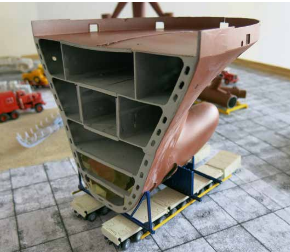
SPMT-Einheiten transportieren die Bug-Sektion eines Riesenfrachters.
