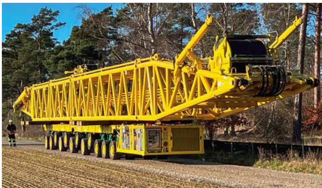
42 Meter lang und 53,8 t schwer: der Derrick-Ausleger.
