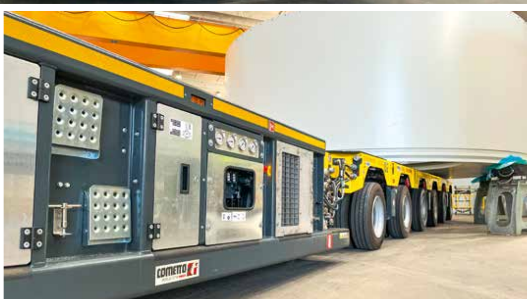
Das 6-Achs ModulMAX SP-E hat die Last in der Halle aufgenommen und kann mit Elektroantrieb herausgefahren werden.
