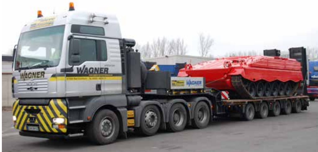
Als Neuheit präsentiert Doll in München einen Plattform-Sattelaufleger P3H-Flatneck. Das Bild zeigt einen 5-Achs-Semi-Tieflader, den das Unternehmen zur IAA 2006 vorgestellt hat und von dem bereits zehn Einheiten ausgeliefert wurden. STM-Bild
