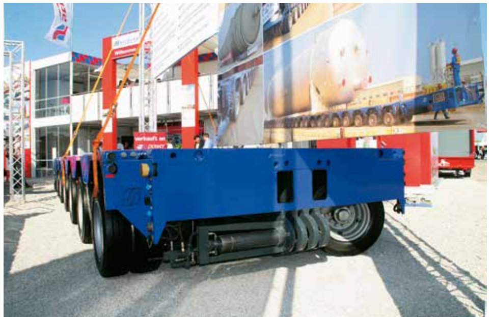
Der „SPMT 3000-SPIC“ ist kompatibel zu den gezogenen Schwerlasteinheiten aus dem InterCombi-Programm von Scheuerle. Der ideale Einstieg für Schwerlasttransporteure in das Selbstfahrer-Segment also.
