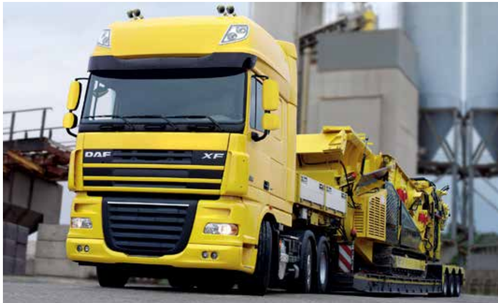
Die Baureihe XF 105 – im Bild der XF 105 FTG 6x2 – wird um eine 8x4-Zugmaschine erweitert. Die besonders schwere Variante weist ein maximales technisches Fahrzeuggesamtgewicht von 41 t auf.
