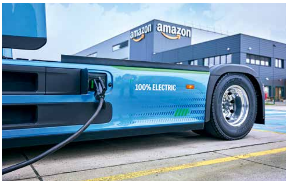
Der eActros 600 wird neben dem CCS-Laden mit bis zu 400 kW später auch das Megawattladen bieten.
