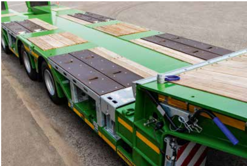
Verschiedene Beläge für maximale Langlebigkeit: ein Holzbelag zwischen den Achsen, Riffelblech über den Achsen und ein Gummibelag auf den hydraulisch verstellbaren Rampen. Dank der Radmulden – hier zum Überfahren abgedeckt – kann der Faymonville MultiMAX für den Transport zahlreicher Baumaschinen eingesetzt werden.
