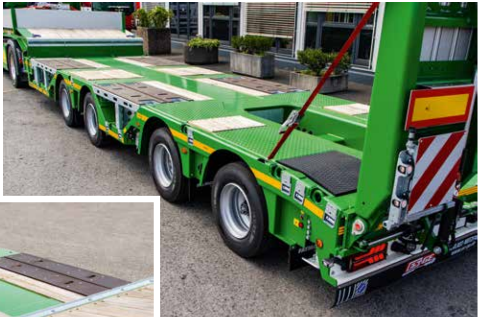
Verschiedene Beläge für maximale Langlebigkeit: ein Holzbelag zwischen den Achsen, Riffelblech über den Achsen und ein Gummibelag auf den hydraulisch verstellbaren Rampen. Dank der Radmulden – hier zum Überfahren abgedeckt – kann der Faymonville MultiMAX für den Transport zahlreicher Baumaschinen eingesetzt werden.
