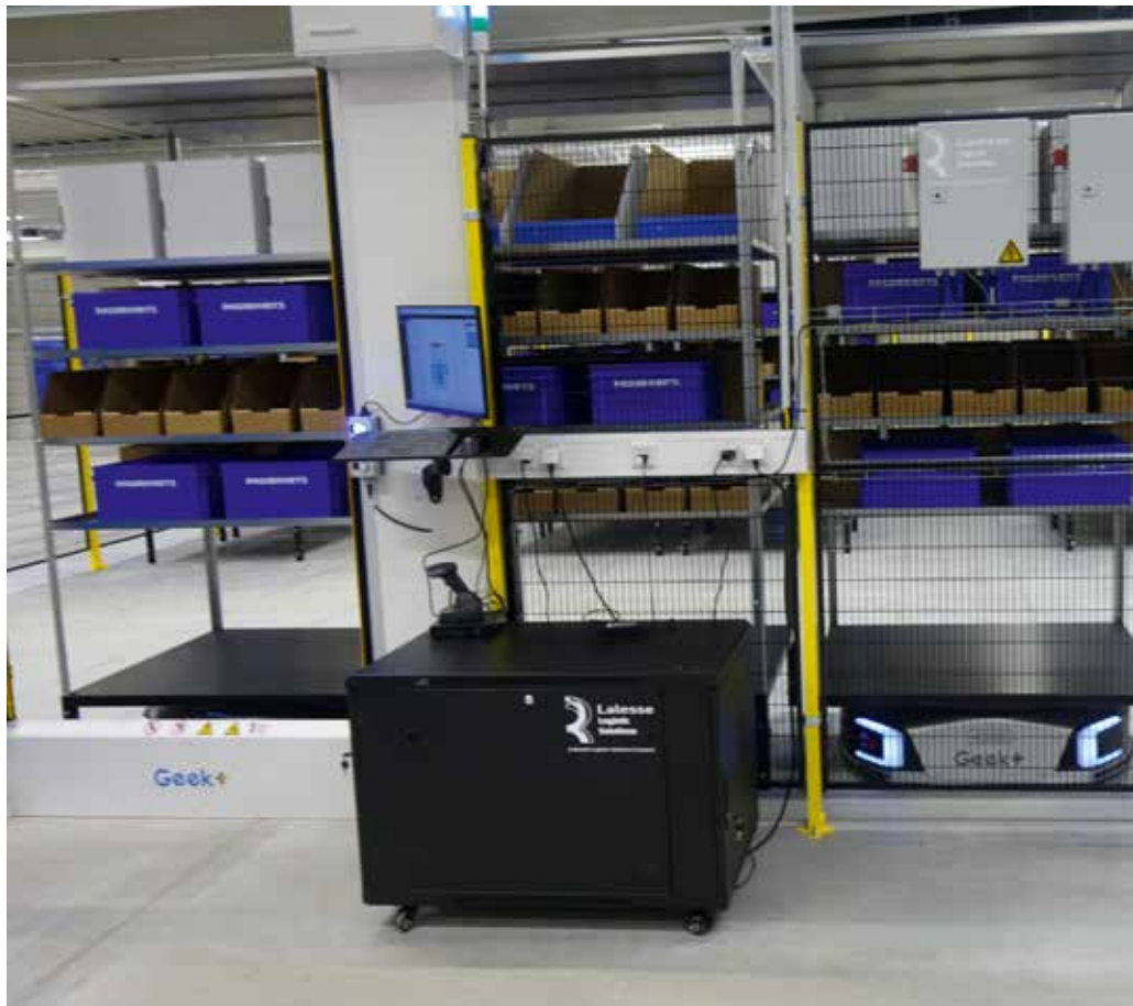
Die Zukunft des Kleinteilelagers: mit automatisierten Ersatzteilwagen kommen die Kleinteile zu einer Ausgabestelle, wo sie dann von dem Mitarbeiter entnommen werden, der dann nicht mehr die Regale ablaufen muss. STM-Bild
