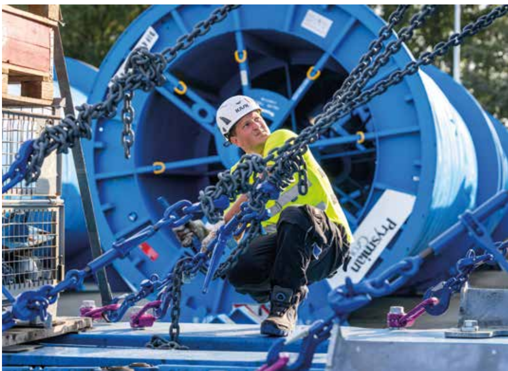
Aufgrund des Gewichtes von bis zu 100 Tonnen kommt der Ladegutsicherung der Spulen besondere Bedeutung zu. Dafür entwickelte der Felbermayr-Bereich Engineered Solutions eine spezielle Vorrichtung. Diese wurde auch im Hause Felbermayr gefertigt.
