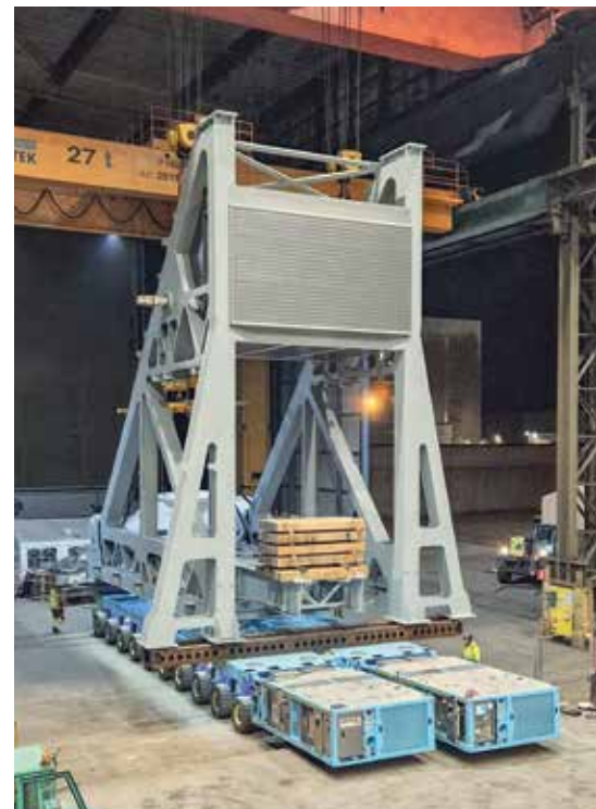
Für den Transport setzte das ausführende Unternehmen Jinert auf eine 10-Achs-Kombination im side-by-side-Modus.
