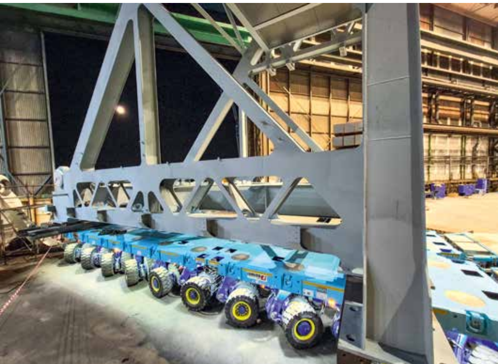
Dank der kompakten Bauweise der Cometto-Selbstfahrer gelang es, selbst enge 90-Grad-Wendemanöver in der Halle und die knifflige Ausfahrt durch das Hallentor präzise zu meistern.
