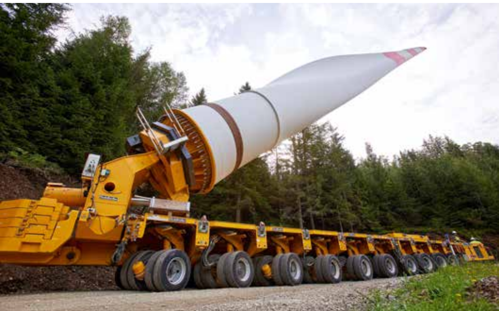
Flügeltransport mit Hilfe eines Selbstfahrers von Goldhofer.
