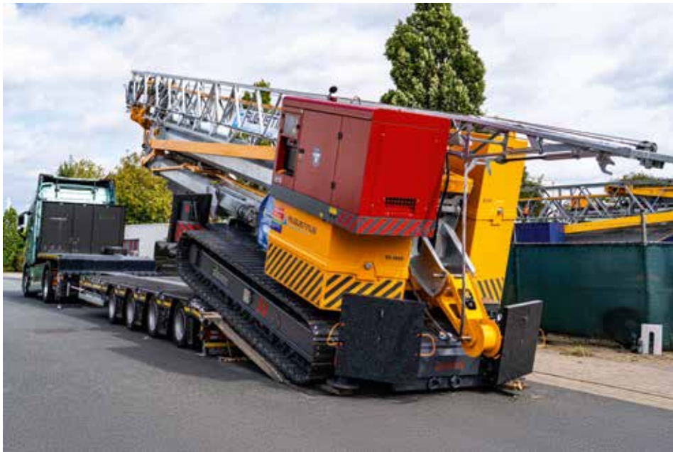
Einzigartig: »STEPSTAR« mit »CARGOPLUS«-Bereifung ermöglicht eine Fahrhöhe von 790 mm bei 10 Tonnen Achslast.
