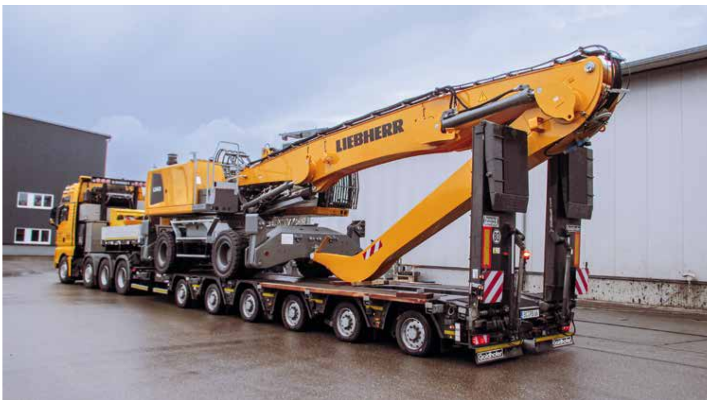
»ARCUS« P mit »CARGOPLUS« Bereifung: Ladehöhe von nur 735 mm.
