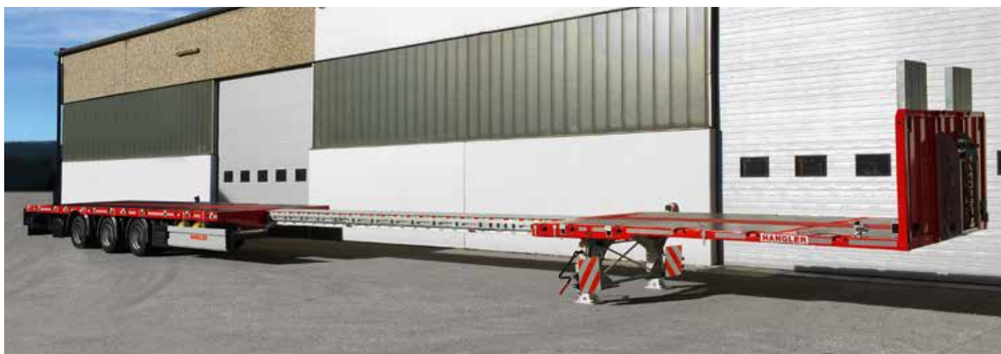
Ebenfalls in München zu sehen: der Dreiachs-Plateausattelaufleger SDS-H 480 Tele Mega-Z für extra langes Transportgut.
