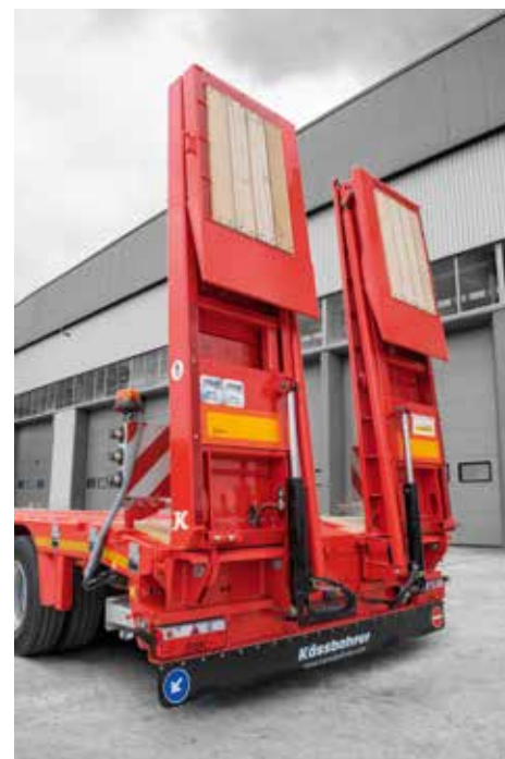
Bis zu 40 Tonnen Kapazität bietet beispielsweise die Rampen der starren K.SLS-Tieflader.
