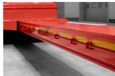
Dank der Teleskopierbarkeit einiger Kässbohrer-Tieflader-Serien können zum Beispiel auch überlange Betonbaufertigteile transportiert werden.
