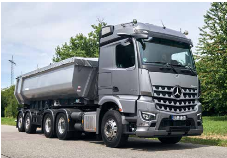
Die Baureihen Actros und Arocs (Bild) können mit dem zuschaltbaren hydraulischen Vorderradantrieb Hydraulic Auxiliary Drive (HAD) ausgestattet werden.
