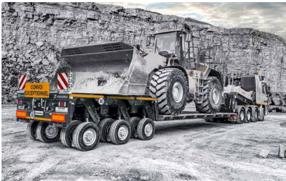
EuroCompact: Maximale Flexibilität dank neuem Schwanenhals und zweifach teleskopierbarer Brücke – ideal für den wirtschaftlichen Transport schwerer und sperriger Lasten.
