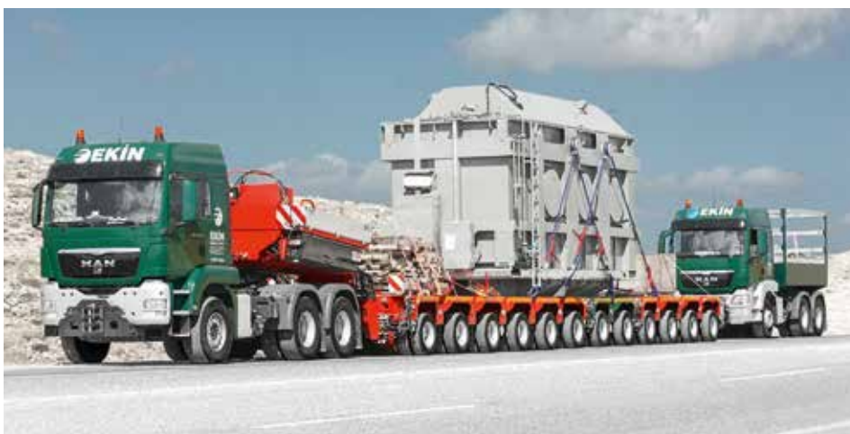
Die SCHEUERLE K25 Schwerlastmodule ermöglichen den effizienten Transport übergroßer und schwerster Lasten. Von Baufahrzeugen, großen Bauteilen bis hin zu Transformatoren. Dank der modularen Bauweise des K25 lässt sich das System flexibel anpassen.
