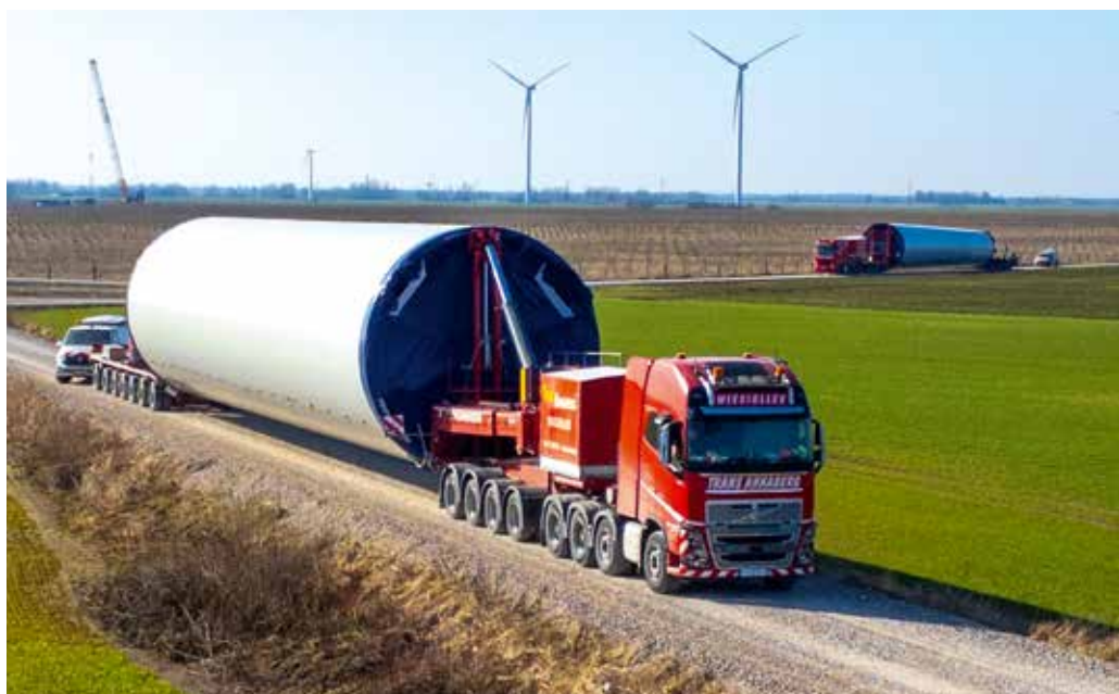
Transannaberg aus Polen transportiert mit dem neuen Mega Windmill Trailer von Nootboom Turmsegmente für Windkraftanlagen.
