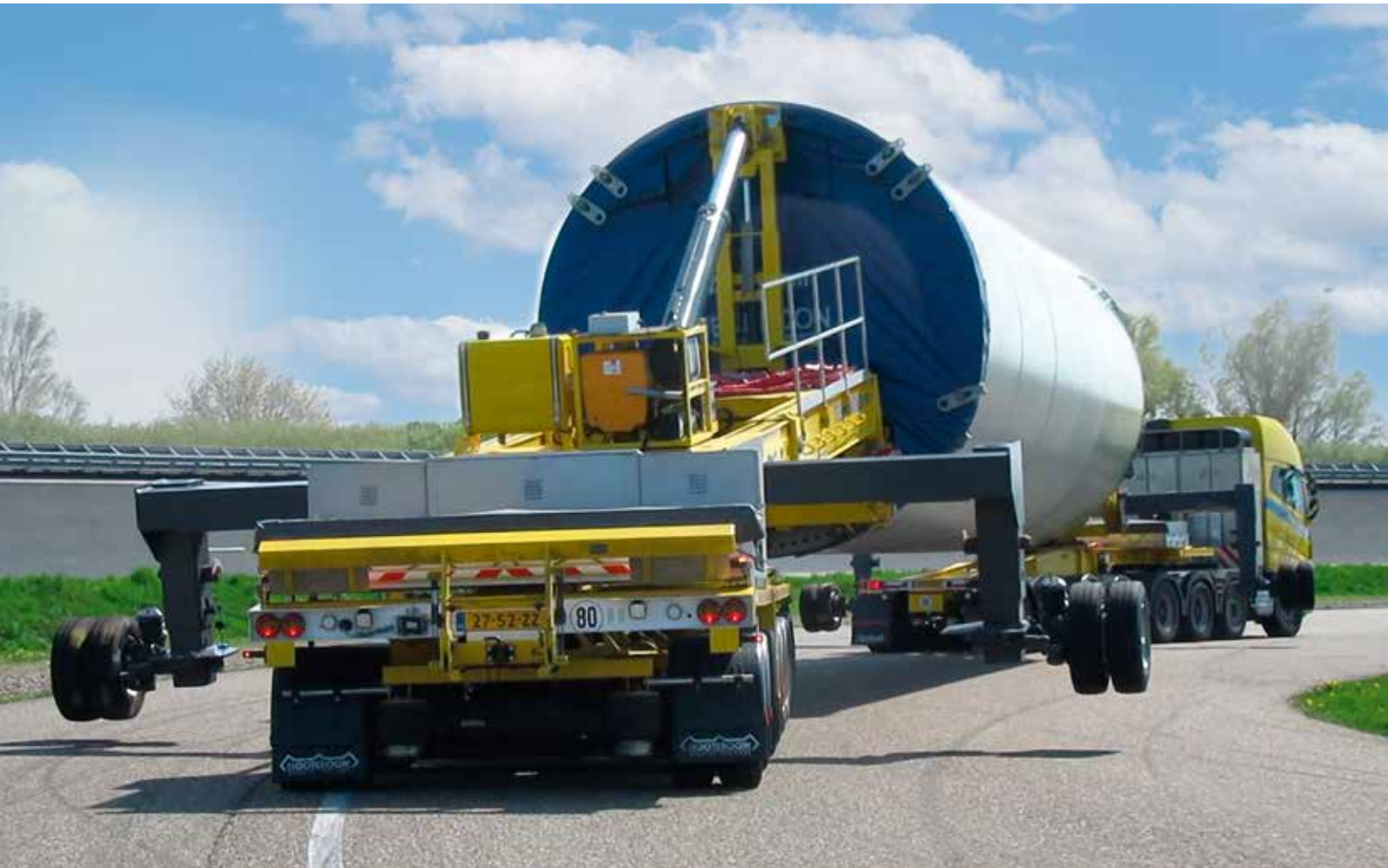
Für die Stabilitätsprüfung wurde das Fahrzeug mit Stützrädern ausgestattet.
