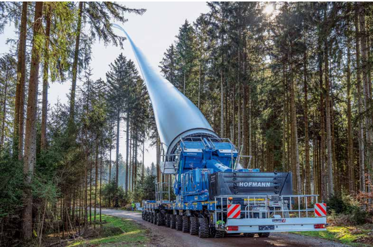
Der Flügel ist aufgestellt, sodass das Fahrzeug zwischen den Bäumen hindurch manövriert werden kann.
