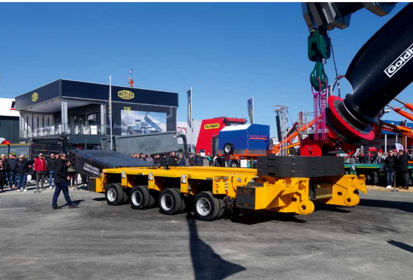
Lockte zahlreiche Besucher an: die Live-Vorführung des hydraulisch verbreiterbaren PST/SL-E split „Widening“ mit E-PowerPack.
