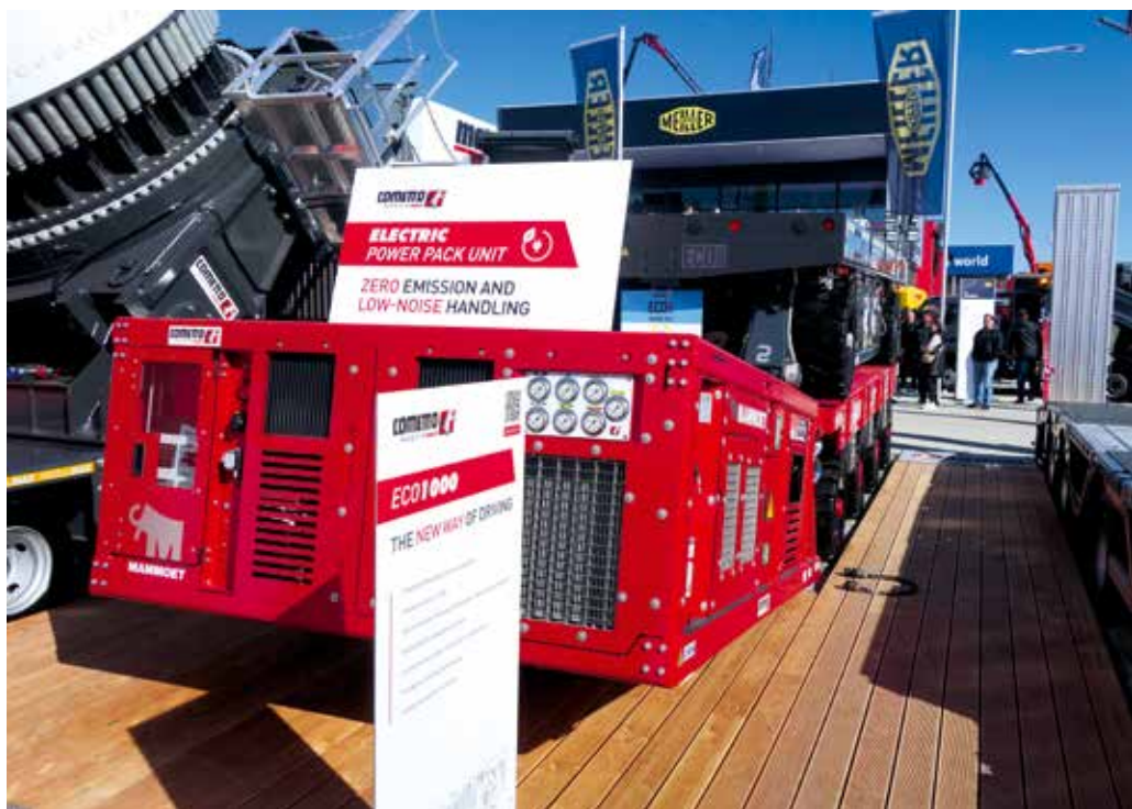
... die neue elektrische Power Pack Unit für SPMTs.
