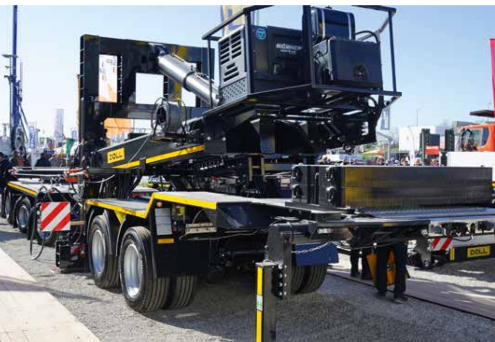
War ebenfalls in München vor Ort: das Windflügeltransportsystem bestehend aus Dolly, Hubadapter, und 4-Achs-Nachläufer für Windflügel bis 120 m.
