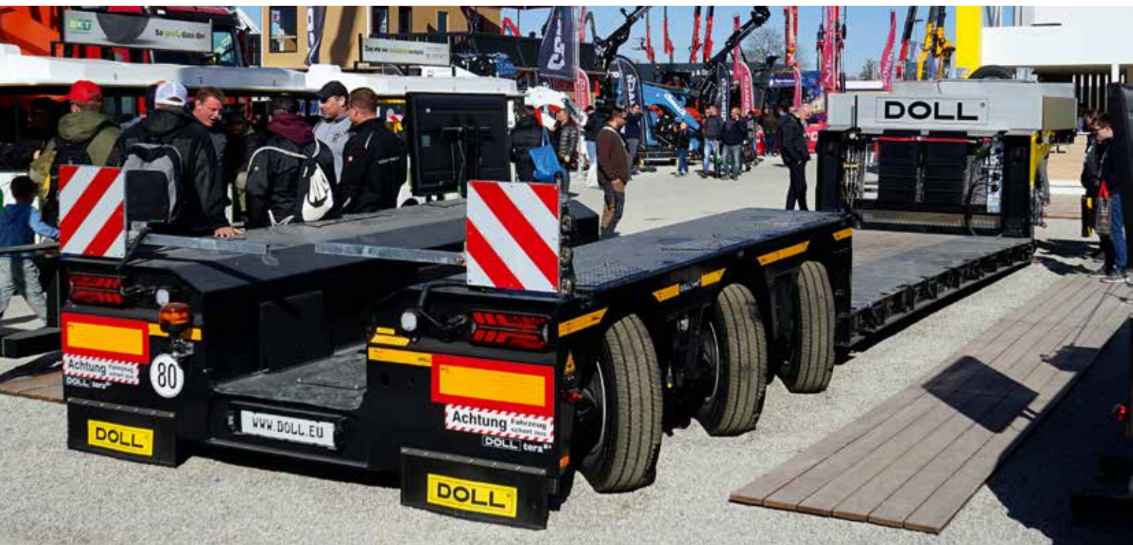
Das 3-achsige DOLL Tiefbett mit DOLL tera Pendelachse.
