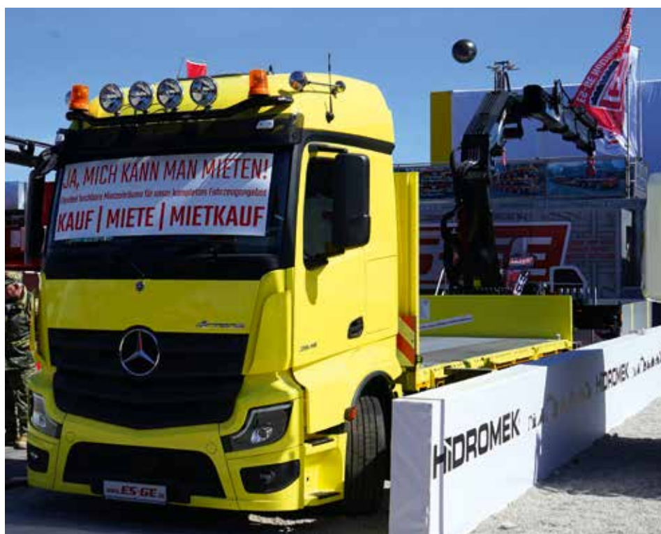
Der MKD Ladekran vom Typ HLK 531HP a7 war am Heck des Mercedes-Benz Actros 2546 6x2 aufgebaut. STM-Bild
