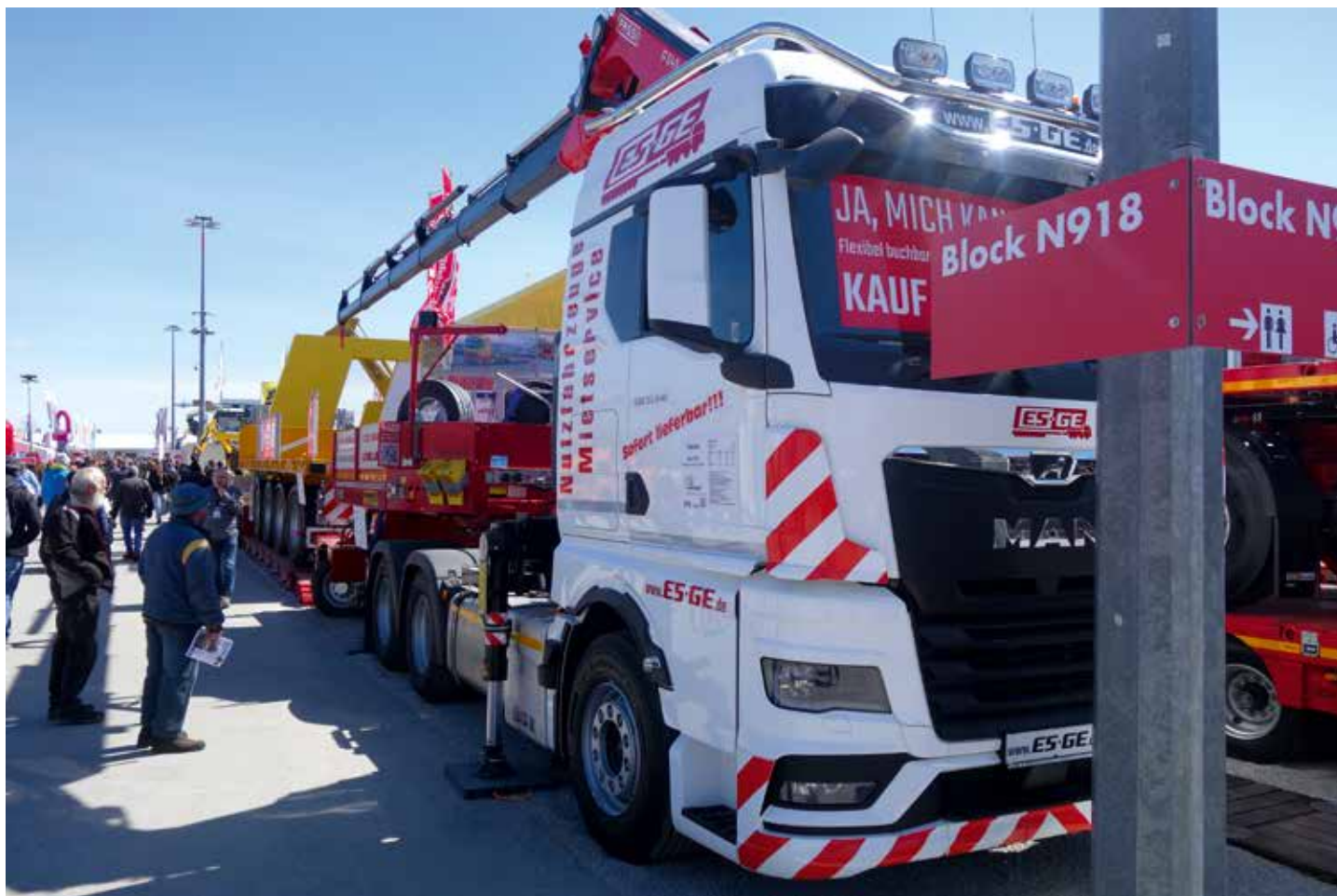
ES-GE hatte zwei Fahrzeuge mit Ladekran auf der bauma ausgestellt: hier der MAN TGX 33.450 6x4 mit Fassi-Ladekran F545RA.2.26 xe-dynamic direkt hinter dem Fahrerhaus aufgebaut. STM-Bild
